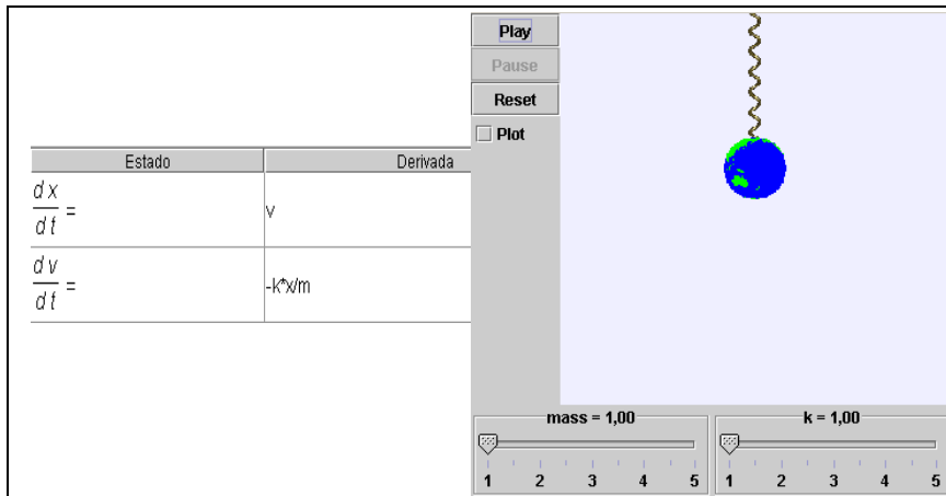
Figura 22. Modelo e interfaz gráfica de un sistema masa-resorte.
